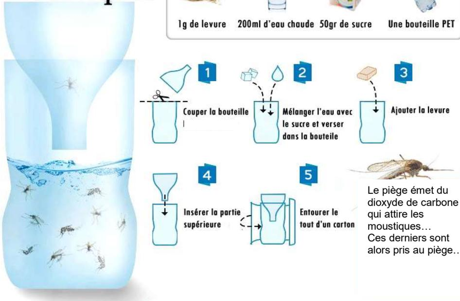
Le piège émet du dioxyde de carbone qui attire les moustiques... Ces derniers sont alors pris au piège...
